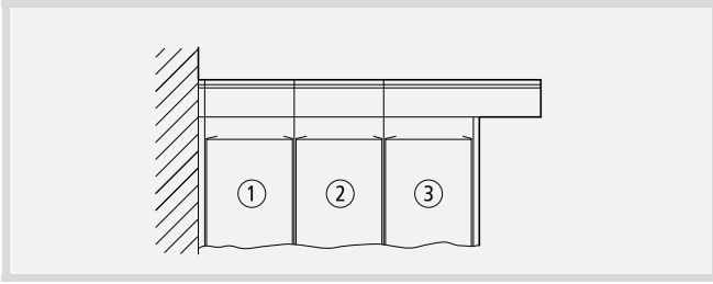
Frontansicht – Lichtbogenabweisblenden montiert.
