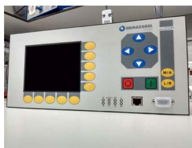
Eine Zusatzlösung für das Datenmanagement ist die Feldsteuereinheit ekor.ccp. Der Monitor zeigt die vollständige Anlage als Blindschaltbild. Foto: Ormazabal
